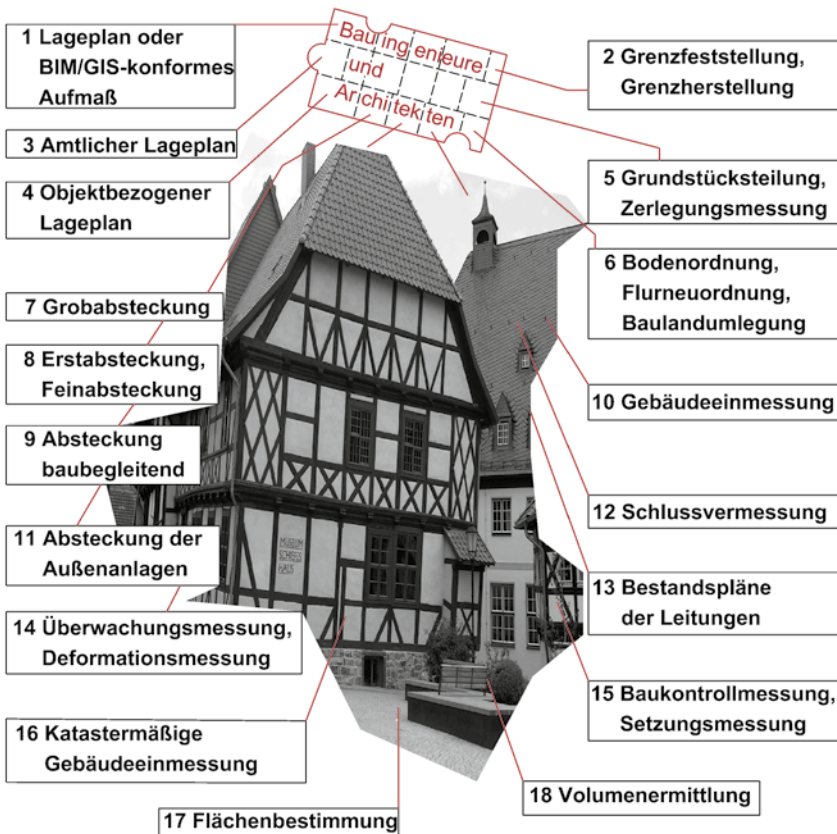
Bild 2.1 Vermessungsaufgaben für bauliche Anlagen
