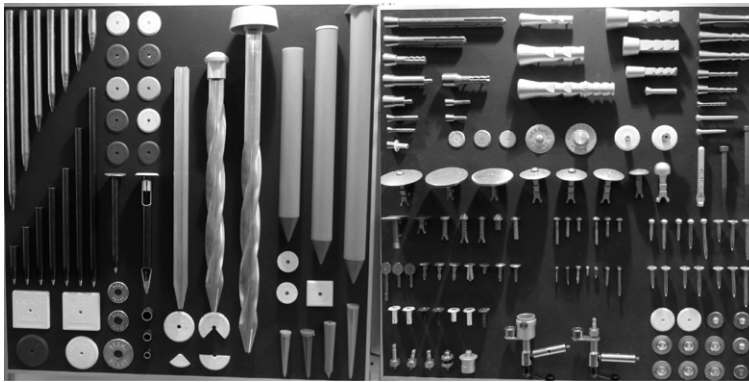
Bild 2.6 Rohrvermarkungen, Höhenbolzen und Festpunktnägel
