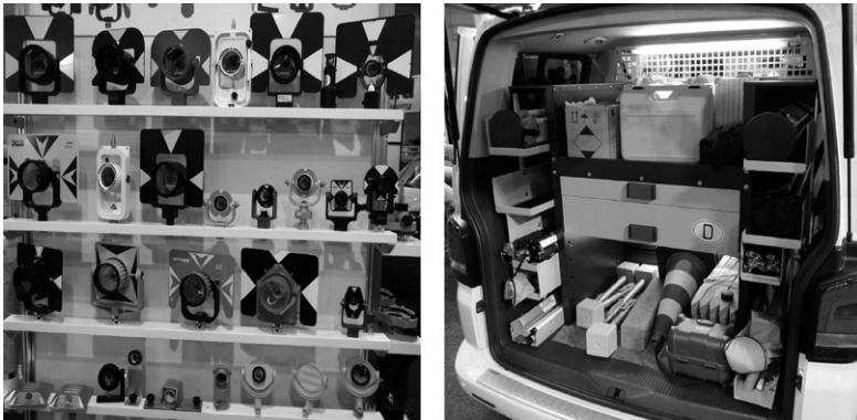
Bild 2.4 Reflektorprismen-Vielfalt und Blick auf die Messbusausstattung
