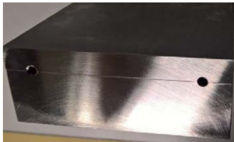
Abb. 4: Additive Fertigung über zwei Bauteile
