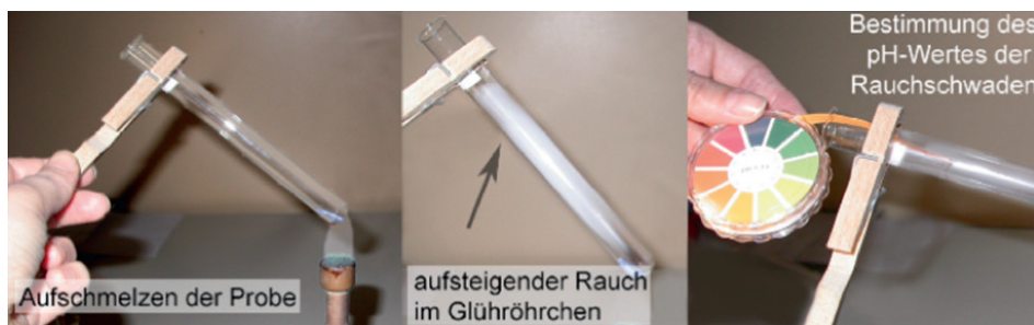
Bild 1.5 Glühröhrchentest mit anschließender pH-Wert-Messung mit Indikatorpapier (LKT)
