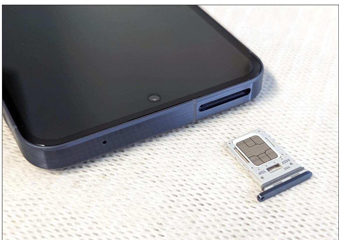
Zum Öffnen der SIM-Schublade auf der Geräteoberseite verwenden Sie das mitgelieferte Stechwerkzeug. In der Schublade befindet sich ein Loch, in das Sie mit dem Stechwerkzeug hineindrücken. Daraufhin springt die Schublade auf und kann mit den Fingernägeln herausgezogen werden.
