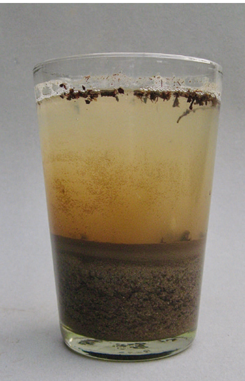
Eine Schlämmprobe gibt Aufschluss über die Bodenart.
