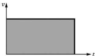
**Bild 2.5** Geschwindigkeit-Zeit-Diagramm einer gleichförmigen Bewegung
