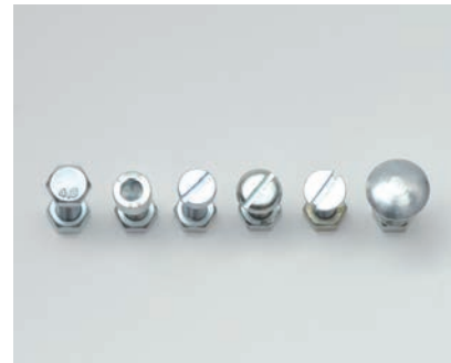
Einige der häufig verwendeten Gewindegewindeschrauben: Sechskantkopf, Inbus, Zylinderkopf, Halbrundkopf, Senkkopf, Schloss.
