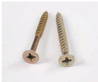
Spanplattenschrauben mit durchgehendem und Teilgewinde. Schrauben mit Teilgewinde benutzt man zum Befestigen von Leisten.
