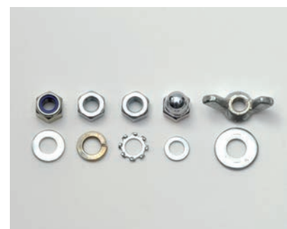
Zu den Muttern gehört eine Unterlegscheibe und gegebenenfalls eine Sicherung gegen Lösen. Am bequemsten: die selbstsichernde Mutter. Federring oder Zahnscheibe tun es auch. Die Hutmutter deckt das Gewindeende ab. Rechts eine Flügelmutter, falls die Verbindung häufiger gelöst werden soll.
