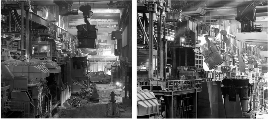
Bild 2.4 Oxygenstahlwerk von ThyssenKrupp Steel in Duisburg Bruckhausen mit Roheisenbehälter (Roheisenpfanne) und Entschwefelung im Vordergrund (beachte Funkenflug) (links), Einfüllen von Roheisen in den Konverter (rechts); ©thyssenkrupp Steel Europe
