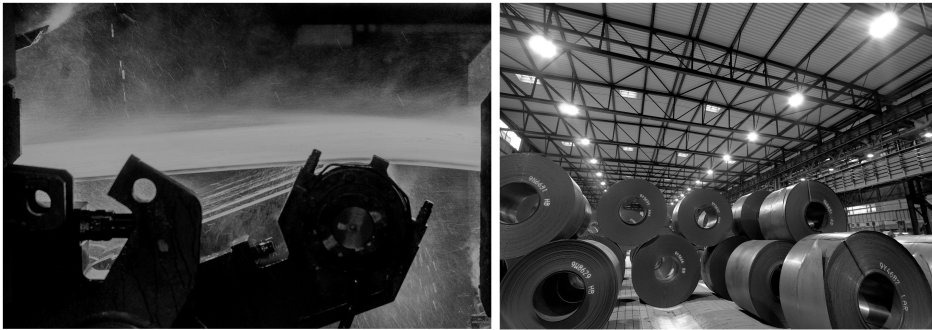
Bild 2.7 Blick zwischen die Walzgerüste auf das ausgewalzte, glühende Stahlblech (links), Warmband-Coils im Lager von ThyssenKrupp Steel in Duisburg Bruckhausen (rechts); ©thyssenkrupp Steel Europe
