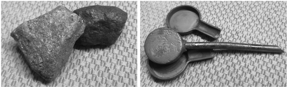
Bild 2.2 Eisenerzgestein (links), Stahlprobe aus einem Stahlwerk zur Analyse der chemischen Zusammensetzung der Stahlschmelze
