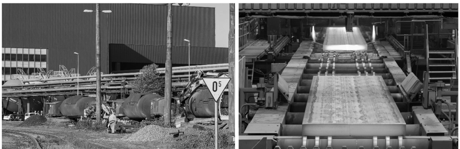
Bild 2.5 Torpedopfannenwagen vor dem Stahlwerk (links), erstarrte aber noch glühende Bramme am Ausgang der Stranggießanlage (rechts); ©thyssenkrupp Steel Europe
