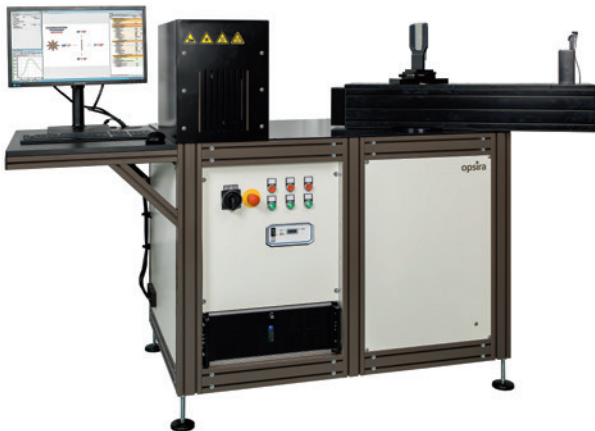
Abb. 2.14 In-Plane-Streulichtgoniophotometer zur Messung der spektralen Streuung (BSDF) von Materialien (Quelle: opsira GmbH)
