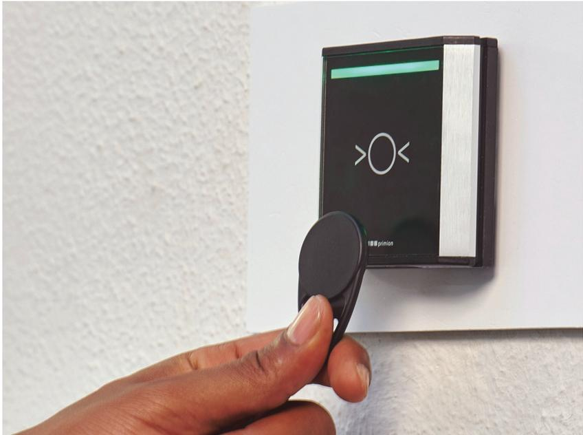
*Abb. 1.10* Beispiel für ein RFID-Lesegerät mit kontaktlosem Datenträger (Transponder), im praktischen Einsatz in einem Zutrittskontrollsystem.
