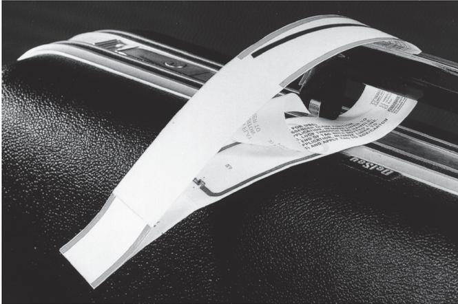
Abb. 2.14 Smart Label Transponder sind dünn und flexibel genug, um sie als Selbstklebelabel am Fluggepäck anzubringen. (Foto: i-code-Transponder, Philips Semiconductors, A-Gratkorn)
