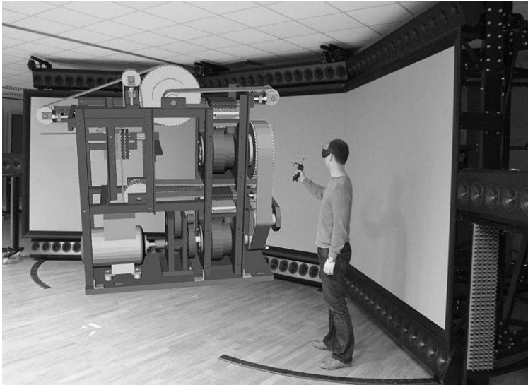
Bild 2.30 Vergrößerte Darstellung einer Pick- und Place-Baugruppe im virtuellen Raum
