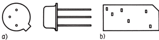
Bild 2.19 Unsymmetrie erleichtert eindeutige Zuordnung zur Umwelt bei Montage eines Transistors (a), eines Schnittteils (b)
