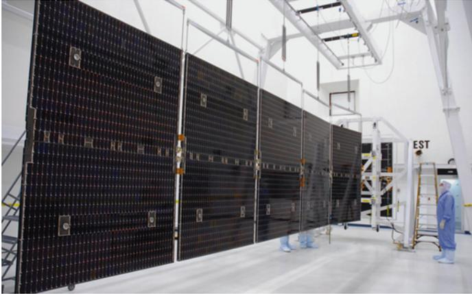
**Bild 1.14** Modernes Solararray der Raumsonde Dawn mit einer Leistung von 5 kW (Foto: NASA)
