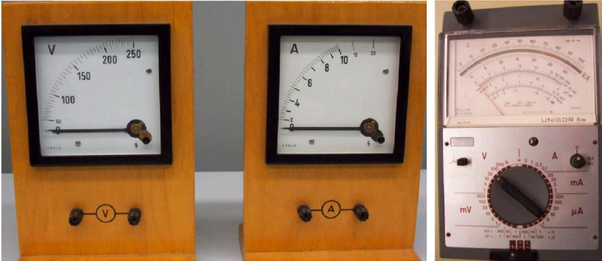
**Bild 1.2** Elektromechanische Voltmeter
