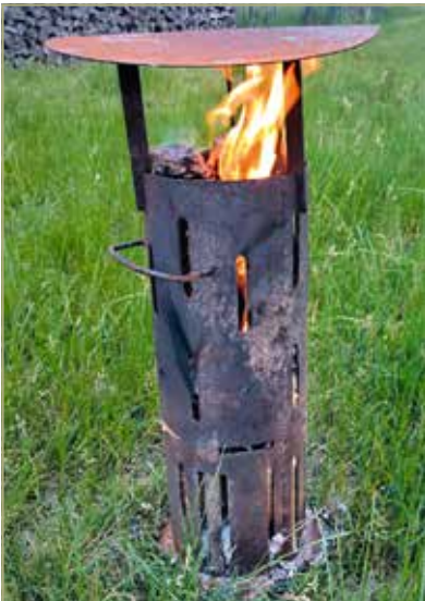
Abb. 2: Ofen zur Frostbeheizung mit fossilen Brennstoffen.
