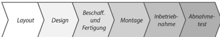
**Abbildung 3: Typischer Projektablauf im Produktionsanlagenbau**
