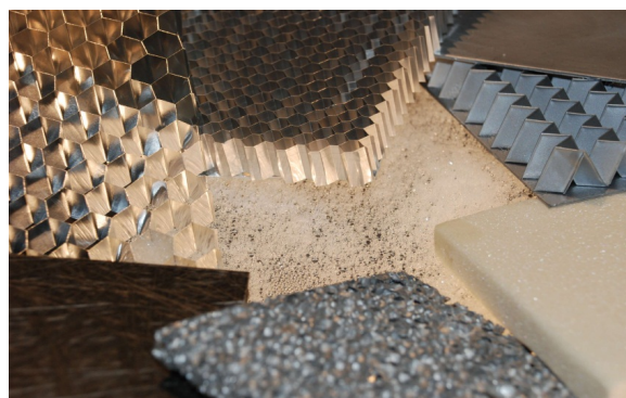
Abb. 3.16: Unterschiedliche Kernmaterialien für Sandwichstrukturen (Kopp et al. 2009)
