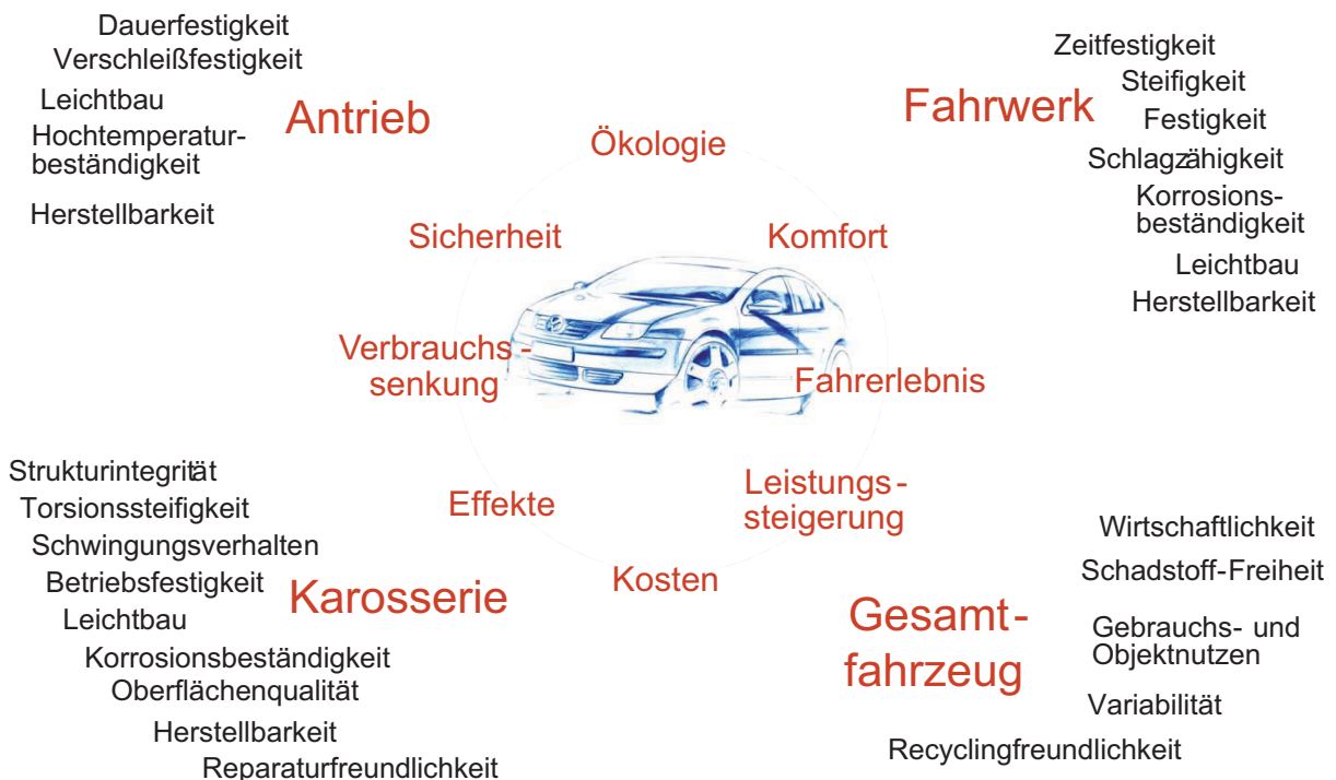
Abb. 3.1: Anforderungen an die Module und Baugruppen im Automobilbau (Braess und Seifert 2003)
