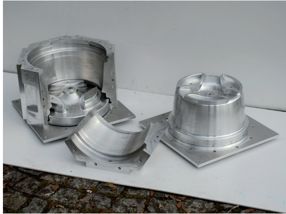
Abb. 1.20: Form zur Herstellung der Felge
