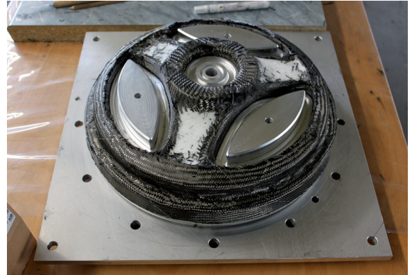
Abb. 1.23: Eingelegter laminiertes Schaumkern in der Form
