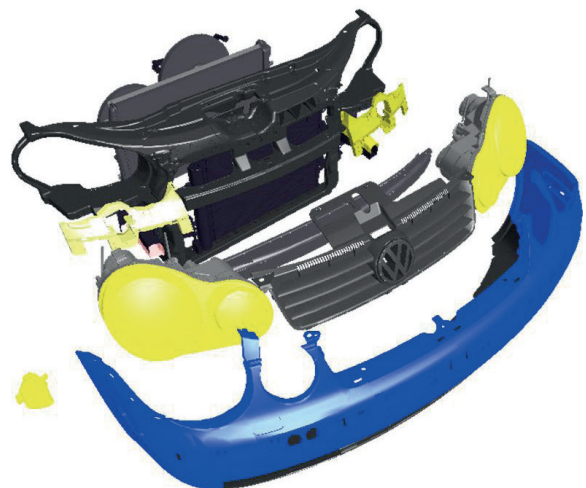
Abb. 3.15: Frontend in Modulbauweise am Beispiel des VW Polo (Henning 2005)
