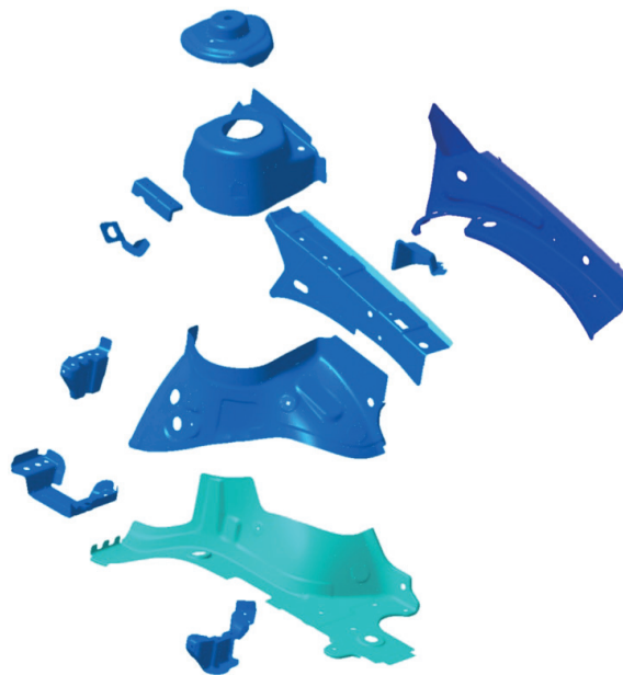
Abb. 3.13: Fahrzeugstruktur in Differentialbauweise (Super Light Car)
