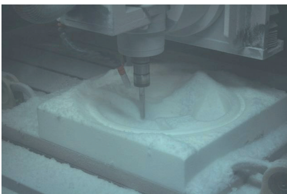
Abb. 1.21: Fräsen der Kunststoffform zum Einlegen in die Kavität
