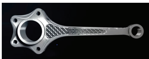
Abb. 2.11: 3D-Druck eines Leichtbauteils (Quelle: Sculpteo)
