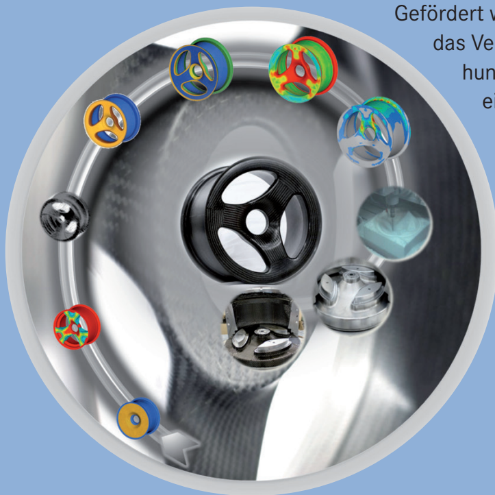
Ergebnisse der Aktivitäten der Produktentstehung am Beispiel einer Felge aus Kohlenstoffaserverbundwerkstoff
