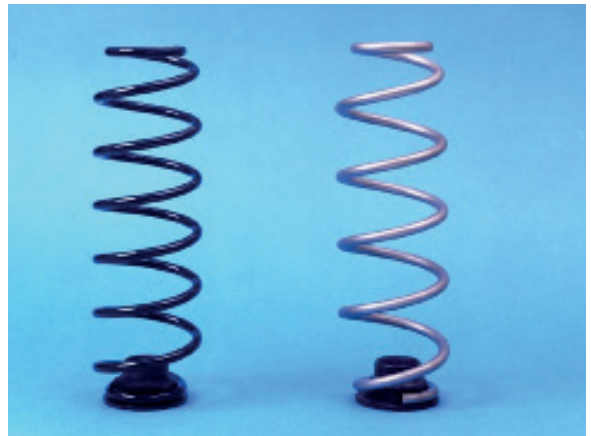
Abb. 3.6: Hinterachsfedern eines Fahrzeugs aus Stahl und Titan (Schauerte et al. 2001)
