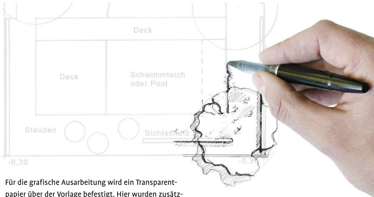
Für die grafische Ausarbeitung wird ein Transparentpapier über der Vorlage befestigt. Hier wurden zusätzliche Lagen Transparent zwischengelegt, um die Linien der Vorlage abzutönen. Dadurch hebt sich die neue Zeichnung klarer ab.
