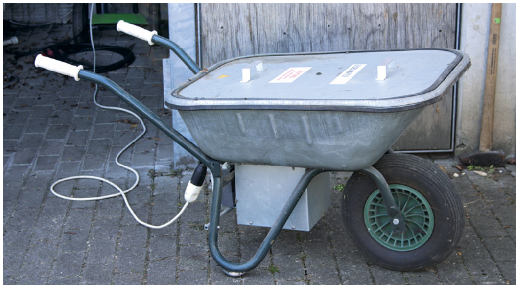
Abb. 5 Erddämpfer zur Hygienisierung von Pflanzerde. Unter der abgedeckten Schubkarre befindet sich eine Art „Wasserkocher“, aus dem heißer Dampf austritt, der die darüber liegende Erde durchströmt.
