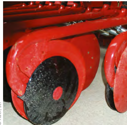
Abb. 1.108 Doppelscheibenschar arbeiten weitgehend verstopfungsfrei.
