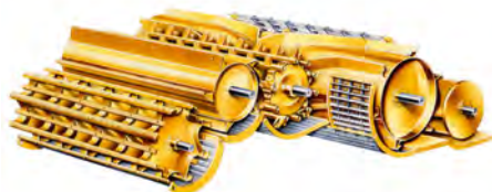
Abb. 1.136 Tangential-Dreschsystem mit Abscheidetrommel und rotierendem Strohabscheider.
