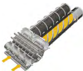
Abb. 1.137 Das Hybrid-Drusch-System mit Abscheiderotoren ermöglicht einen hohen Durchsatz.
