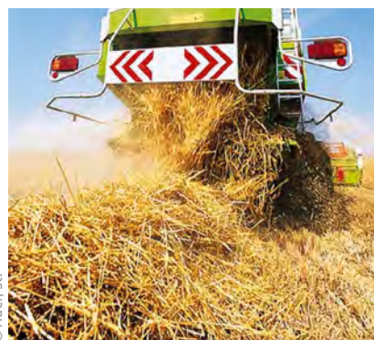
Abb. 1.83 Stroh wird im Schwad abgelegt (oben) oder muss für das spätere Einarbeiten zerkleinert und gleichmäßig verteilt werden (unten).
