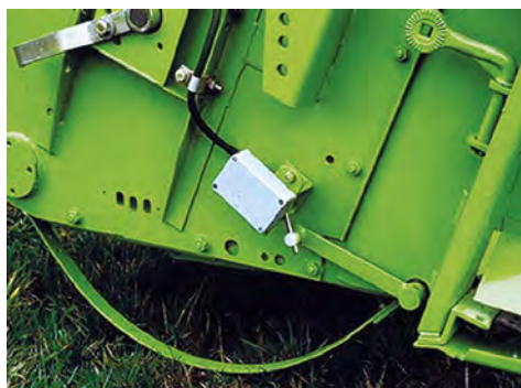
Abb. 1.128 Die automatische Boden Anpassung des Schneidwerkes ist für eine verlustarme Ernte besonders bei Lagergetreide notwendig.
