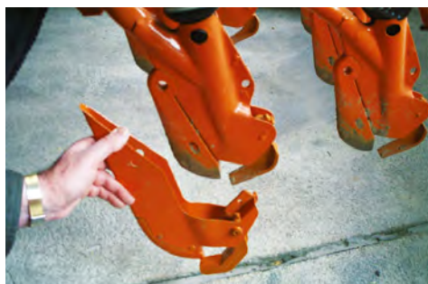
Abb. 1.105 Schleppschar; Anbau eines Schares für tiefere Saat z. B. für Bohnen.
