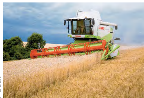
Abb. 1.130 Bei Mäharbeiten mit Hangausgleich bleiben die Schüttler und Siebe bis zu 20 Grad Querhang waagrecht.
