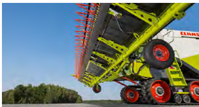
Abb. 1.121 Beim Einsatz von schweren Maschinen schonen breite Reifen oder alternativ Raupenfahrwerke den Boden.
