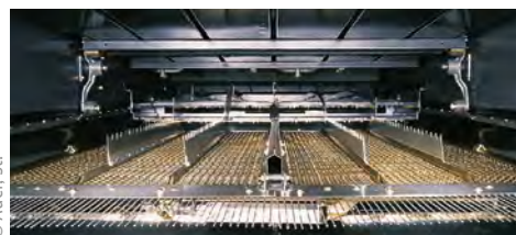
Abb. 1.82 Für eine verlustarme Ernte sind große Abscheideflächen notwendig.
