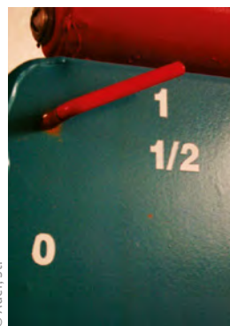
Abb. 1.99 Einfache Füllstandsüberwachung im Saatgutbehälter.
