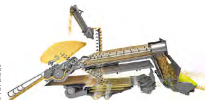
Abb. 1.143 Das von den Schüttlern bzw. Rotoren abgegebene Material wird von dem Häcksler erfasst, zerkleinert und verteilt.
