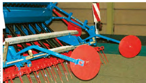
Abb. 1.116 Mit der Fahrgassenschaltung kann eine Vorauflauf-Markierung betätigt werden, die die Fahrgassen markiert.
