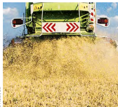
Abb. 1.83 Stroh wird im Schwad abgelegt (oben) oder muss für das spätere Einarbeiten zerkleinert und gleichmäßig verteilt werden (unten).
