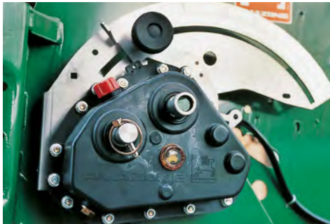
Abb. 1.119 Den Ölstand im Getriebe regelmäßig über das »Auge« kontrollieren.
