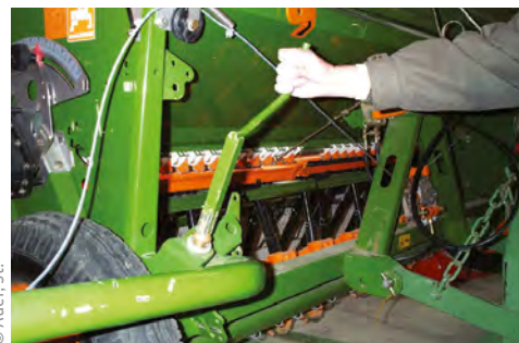
Abb. 1.110 Stufenlose Einstellung der Saattiefe durch Veränderung des Anpressdrucks.
