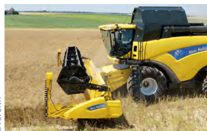
Abb. 1.141 Hydraulisch angetriebenes Seitenschneidwerk für den Rapsdrusch.
