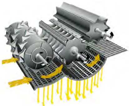
Abb. 1.129 Dreschwerk mit 2 Trommeln und zusätzlicher Abscheidefläche.
