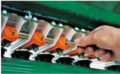
Abb. 1.118 Nachjustieren der Bodenklappen.
