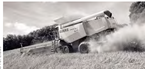
Abb. 1.124 Heutige Getreideschneidwerke nehmen auch Lagergetreide gut auf.
