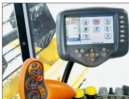
Abb. 1.127 Die Einstellungen am Schneidwerk und der Haspel sind über den Joystick elektrohydraulisch möglich.
