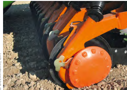
Abb. 1.107 Einscheibenschar mit Noppen-Kunststoffscheibe zur Reinigung und zur Tiefenführung der Stahlscheibe.
