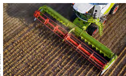
Abb. 1.142 Mit flexiblen Schneidwerken ist eine gute Boden Anpassung beim Sojabohnendrusch möglich.
