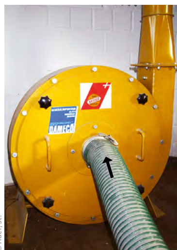
Abb. 1.171 Hammermühle mit eingebautem Gebläse, es übernimmt das Ansaugen des Getreides und die Weiterförderung des Schrotes.
