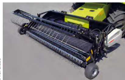
Abb. 1.140 Mit einer speziellen Pick-up ist auch ein verlustarmer Erbsen- und Grassamendrusch möglich.
