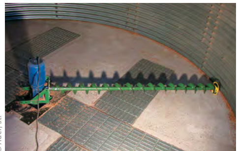
Abb. 1.149 Getreide-Rundsilo mit einer sog. Fegeschnecke.
