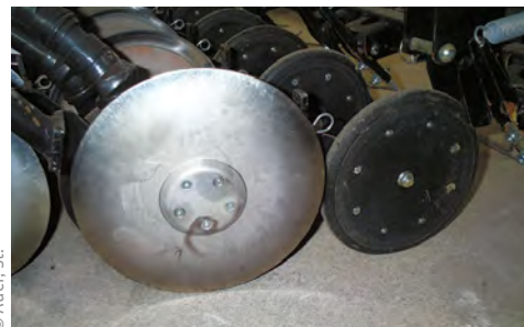
Abb. 1.109 Doppelscheibenschar mit Tiefenführungsrolle.
