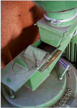
Abb. 1.172 Eine Einspeisung mit Luftregelung arbeitet verstopfungsfrei.
