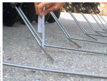
Abb. 1.117 Das genaue Einstellen des Saatstriegels ist wichtig für ein ebenes Saatbett.
