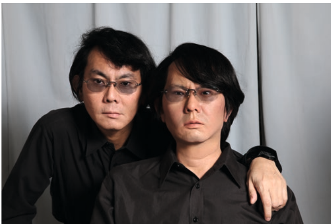
Bild 1.5 Geminoid-HI-4 -Roboter von Hiroshi Ishiguro an der Universität von Osaka entwickelt (© Hiroshi Ishiguro)
