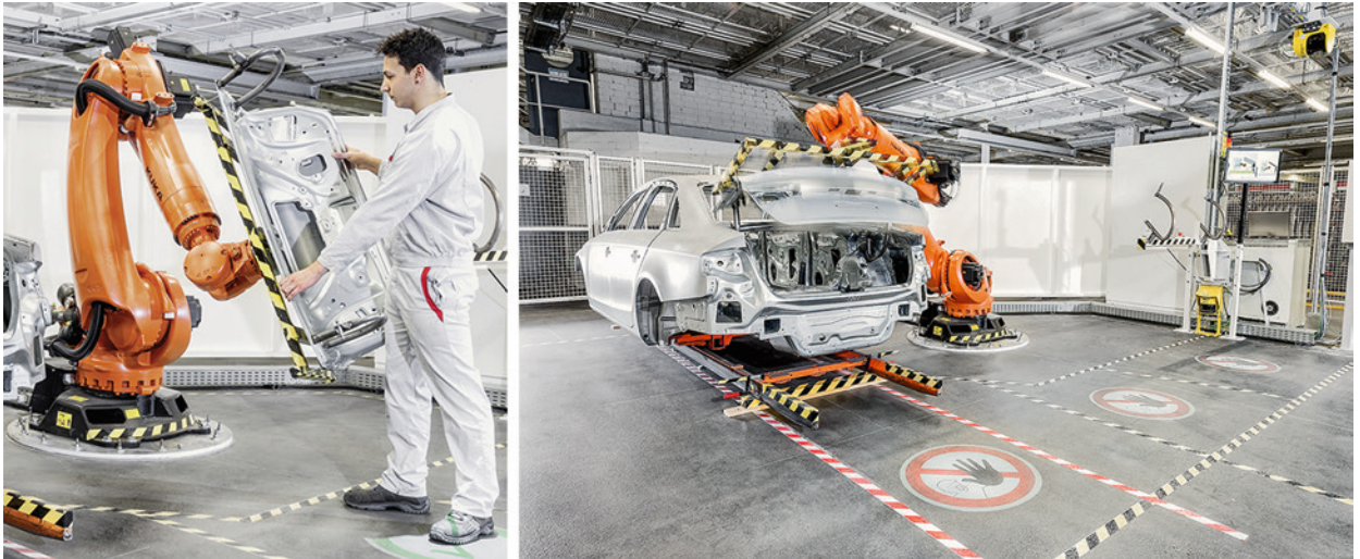
Bild 1.7 MRK-Heckklappenmontage bei AUDI AG (Quelle: Audi AG)
