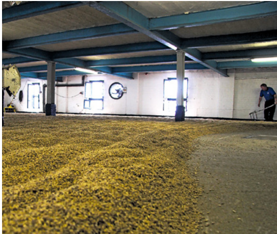
Tennenmälzerei der Bowmore Destille auf der Isle of Islay in Schottland.
