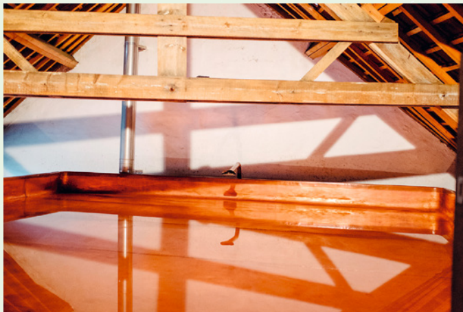
Kühlschiff der Brasserie Cantillon in Anderlecht, Belgien.
