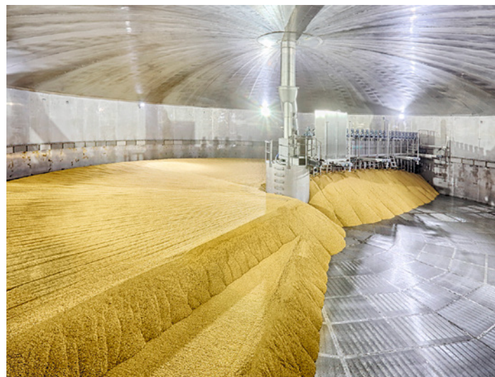
Automatische Wendeanlage einer modernen Turm-mälzerei.
