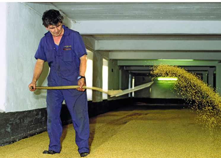
Ein Mälzer wendet das Malz auf der Tenne von Hand. Hier bei Laphroaig auf der Isle of Islay, Schottland.
