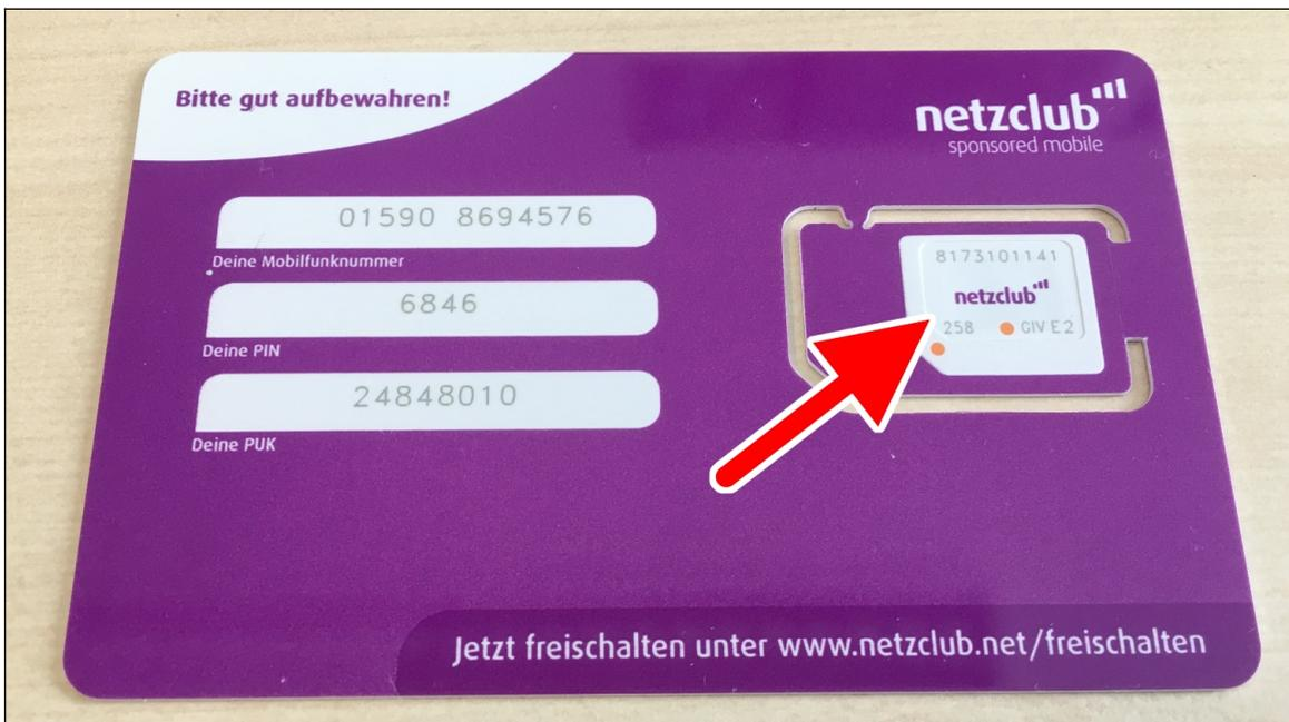
Eine neue SIM-Karte wird immer als große Plastikkarte geliefert. Vorgestanzt sind darin Mini-SIM, Micro-SIM und Nano-SIM, wovon Sie die Nano-SIM (Pfeil) vorsichtig herausbrechen.
