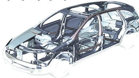
**Bild 1.2** Werkstücksortiment, bestehend aus Karosserieaußenhaut- und Karosserieinnen-Bauteilen
