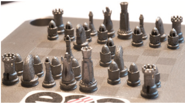
Bild 1.4 Schachspiel aus Metall mit Türmen, Höhe circa 5 mm, Mikro-Lasersintern
