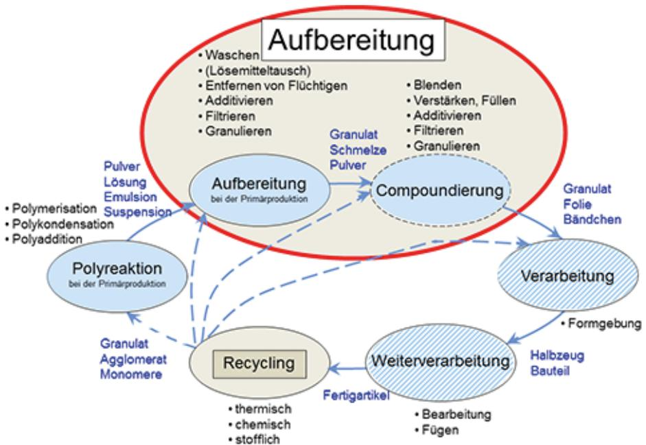
**Bild 2.5** Polymer-Verfahrenstechnik, Übersicht am Beispiel Thermoplast
