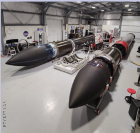
Zwei Electron werden am Startplatz in Mahia auf ihre Mission vorbereitet. Die Rakete rechts, mit dem „Bauchring“ ist bergungsfähig, und damit potentiell wiederverwendbar.
