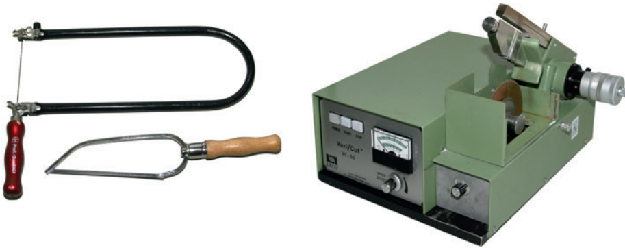
Bild 1.1 Handsägen (links) und Nieder-tourensäge (rechts) zur Probenentnahme
