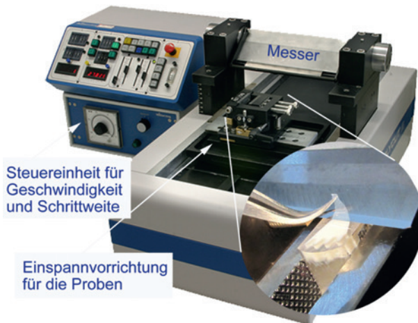
Bild 1.13 Schlittenmikrotom mit fixierter Probe und bewegtem Messer
