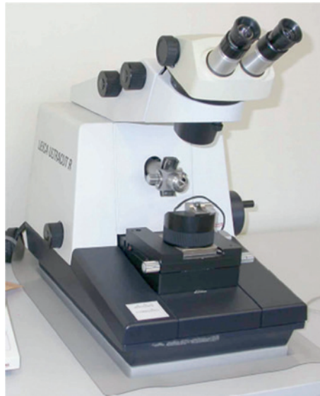
Bild 1.17 Ultramikrotom Schnittdicke: 0,01 bis 0,5 \mu\text{m} ; Präparationen für Transmissionselektronenmikroskopie
