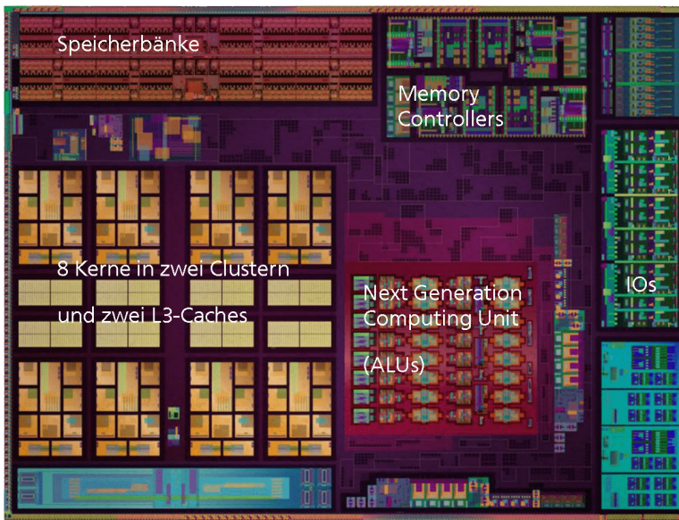
Abb. 4.8: So sieht ein Layout einer CPU aus (Quelle: AMD).
