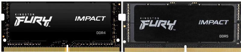
Abb. 4.11: SO-DIMM-Modul einmal als DDR4-SD-RAM und rechts als DDR5-SD-RAM (© Kingston)
