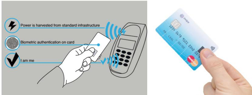
Abb. 1.5 Beispiel für eine kontaktlose Kreditkarte mit integriertem Fingerprintsensor, die Zwipec Mastercard. [zwipec2014] (Grafik und Foto: Zwipec AS Norway)
