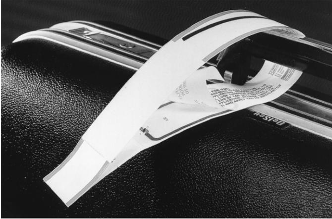
Abb. 2.14 Smart Label Transponder sind dünn und flexibel genug, um sie als Selbstklebelabel am Fluggepäck anzubringen. (Foto: i-code-Transponder, Philips Semiconductors, A-Gratcorn)
