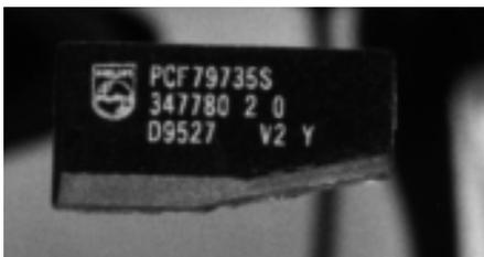
Abb. 2.5 Transponder im Plastikgehäuse. (Foto: Philips Semiconductors, Hamburg)
