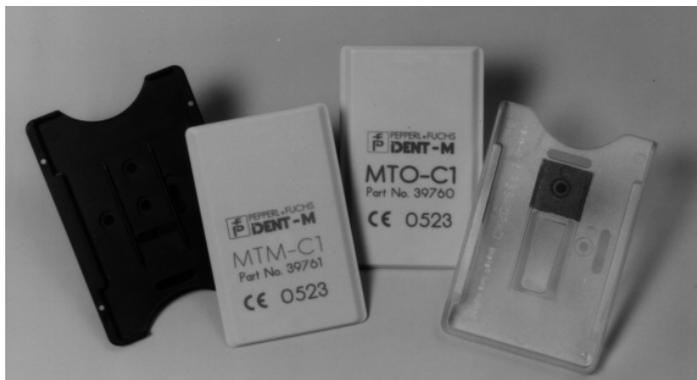
Abb. 2.13 Mikrowellen-Transponder im Kunststoff-Halbschalengehäuse. (Foto: Pepperl & Fuchs, Mannheim)
