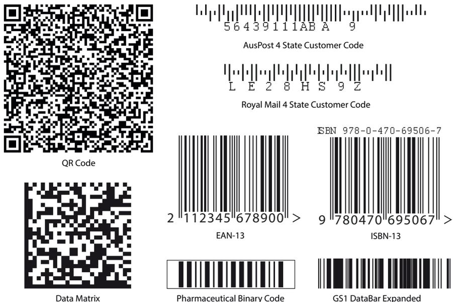
Abb. 1.3 Verschiedene Beispiele für 1D- und 2D-Barcodes.
