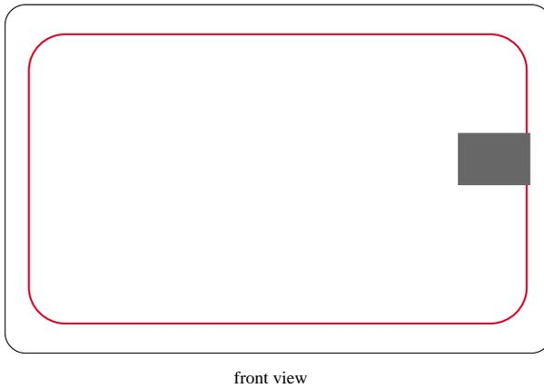
Abb. 2.11 Aufbau einer kontaktlosen Chipkarte: Kartenkörper mit Transpondermodul und Antenne.
