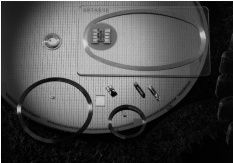
Abb. 3.14 Verschiedene Bauformen induktiv gekoppelter Transponder. Dargestellt sind Transponder-Halbzuge, also Transponder vor dem Einspritzen in ein Kunststoffgehäuse.
