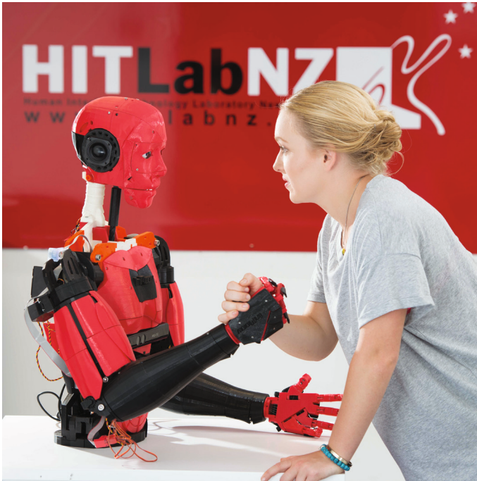
Bild 2.13 InMoov (2012 – heute) kann mithilfe von Rapid-Prototyping-Technologie und leicht erhältlicher Komponenten gebaut werden. Der InMoov-Roboter ist ein sozialer Open-Source-Roboter
