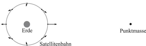
**Bild 2.2.7:** Störbeschleunigung eines Satelliten durch eine weit entfernte Punktmasse.
