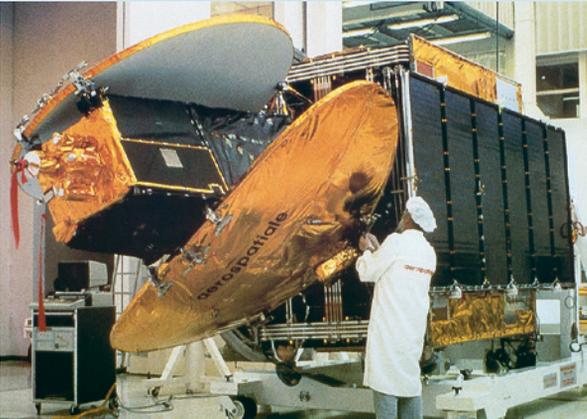
**Bild 1.1.12:** Bei TV-Sat 1 und 2 handelte sich um direkt sendende Satelliten, deren Fernseh- und Radiosignale stark genug waren, um mit 50 cm großen Parabolantennen empfangen zu werden. Nach einem fehlgeschlagenen Entfaltungsmanöver wurde TV-Sat 1 noch vor der eigentlichen Betriebsaufnahme in einen sog. Friedhofsorbit gebracht. Die Starts erfolgten mit Ariane-Raketen (Bild: Aerospatiale).
