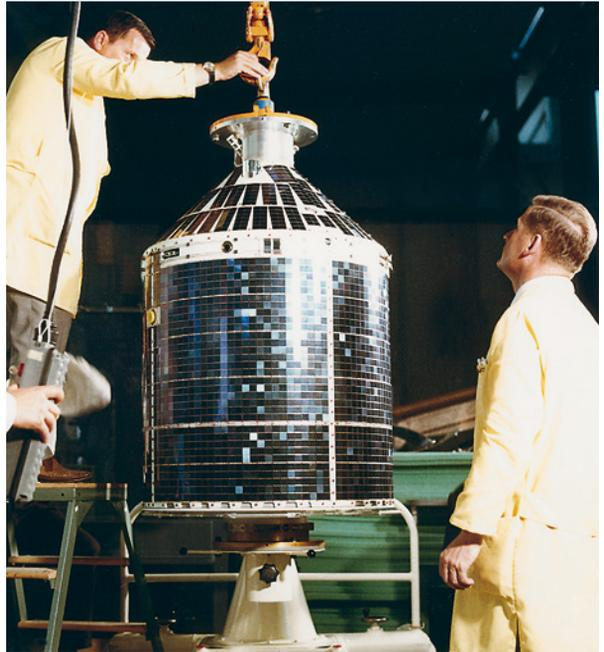
**Bild 1.1.6:** AZUR diente der Erforschung der Strahlungsgürtel der Erde unter Systemführung der Bölkow GmbH. Der Satellit wurde von einer amerikanischen Scout-Rakete auf eine polare Umlaufbahn gebracht. Eine Besonderheit war, dass alle eingesetzten Materialien unmagnetisch sein mussten (Bild: DLR).
