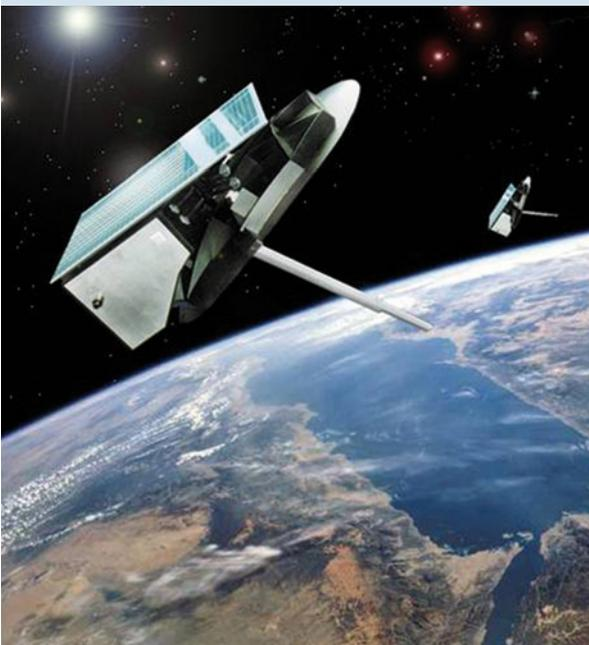
**Bild 1.2.18:** Die zur Radaraufklärung eingesetzten Satelliten der deutschen SAR-Lupe-Konstellation (Bild: OHB System).
