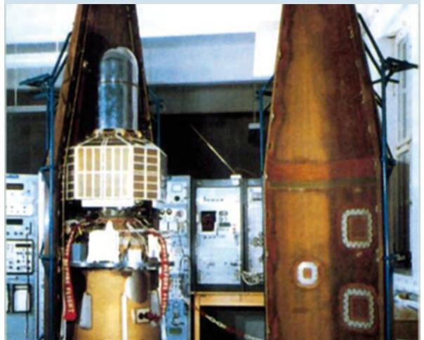
**Bild 1.1.7:** Mit der Mission DIAL/WIKA (WissenschaftsKapsel) wurden vier Experimente (u. a. zur Bestimmung der Elektronendichte) im äquatornahen Orbit zum Einsatz gebracht. Der Satellit konnte nicht aktiv kommandiert werden. Die Mission endete nach etwas mehr als zwei Monaten. Der Start erfolgte mit einer Diamant-B (Bild: EADS).
