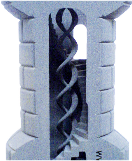
Bild 1.5 Internes Detail eines Turmes aus Formsand (wie Bild 1.2 hinten links)
