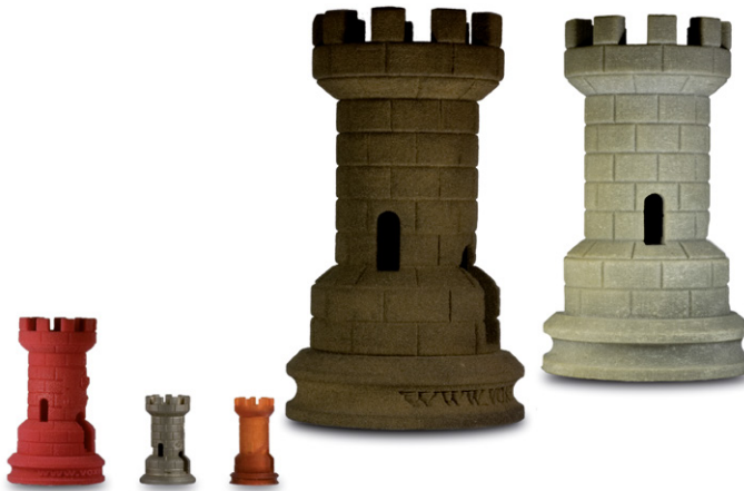
Bild 1.2 Additive Fertigung. Aus dem gleichen Datensatz abgeleitete, aber mit unterschiedlichen Verfahren hergestellte Türme
