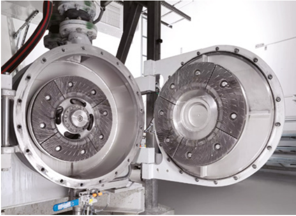
Bild 3.31 TwinFlo-Refiner mit Pluralis-Mahlgarnitur (Quelle: Voith [3.12])
