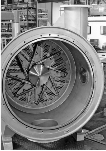
Bild 3.13 Sekundärpulper (Quelle: Voith)
