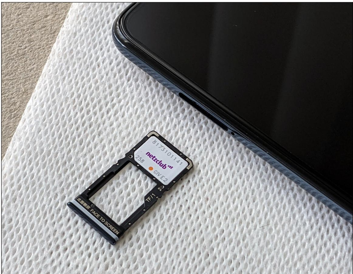
So legen Sie die SIM-Karte ein: Sie drücken mit dem beiliegenden Stechwerkzeug die Schublade durch das kleine Loch auf der linken oberen Geräteseite heraus. Dann legen Sie die SIM-Karte mit den Kontakten nach unten in das Fach. Beim anschließenden Hineinschieben der Schublade ins Handy müssen Sie sehr vorsichtig sein, denn die SIM-Karte darf auf keinen Fall herausfallen oder sich verkannten.
