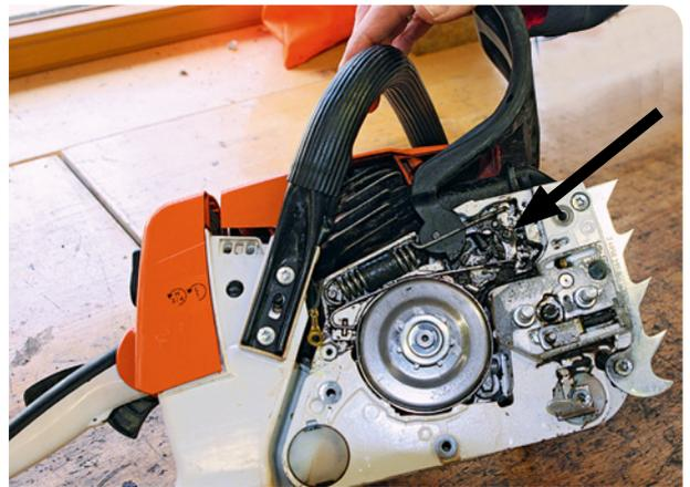
Abb. 2. Kettenbremse. Kettenbremssysteme wie QuickStop Super oder TrioBrake stoppen die Kette bei falscher Bedienung der Säge oder beim Loslassen des hinteren Handgriffes.
