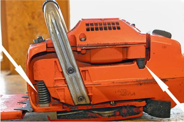
Abb. 9. Antivibrationssystem: Die Baugruppen der Säge sind über Dämpfungselemente miteinander verbunden.
