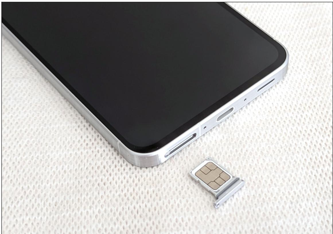
Zum Öffnen der SIM-Schublade an der Geräteunterseite nutzen Sie das mitgelieferte Stechwerkzeug. In der Schublade befindet sich ein kleines Loch, in das Sie mit dem Stechwerkzeug vorsichtig hineindrücken. Daraufhin springt die Schublade auf und kann mit den Fingernägeln herausgezogen werden. Achten Sie darauf, nicht versehentlich in das danebenliegende Loch zu stechen, da dies das Gerät beschädigen könnte.
