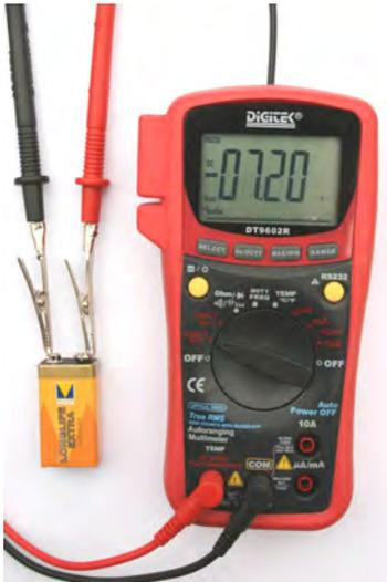
Um eine sinnvolle praktische Anwendung des *SerialPort*-Controls mit geringstem Aufwand zu demonstrieren, verwenden wir hier als Peripheriegerät ein Digitalvoltmeter (z.B. DT9602R) mit serieller Schnittstelle<sup>2</sup>. Es dürfte aber auch jedes andere DVM mit serieller Schnittstelle geeignet sein. Die Abbildung zeigt das DVM beim Messen einer Batteriespannung, oben sieht man das Kabel, welches zum seriellen COM-Port des PC führt.
