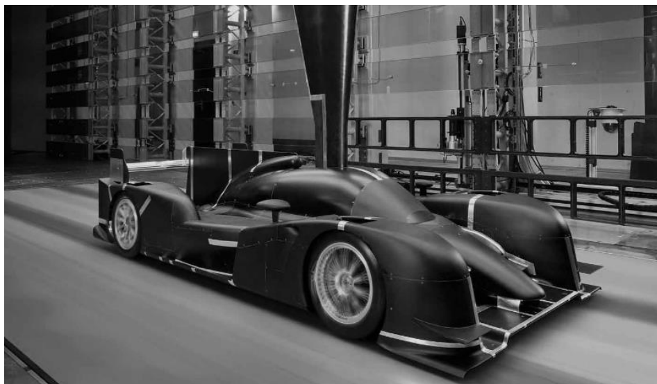
Abbildung 6 - 1:6 Windkanalmodell Toyota LMP1 WEC-Serie
