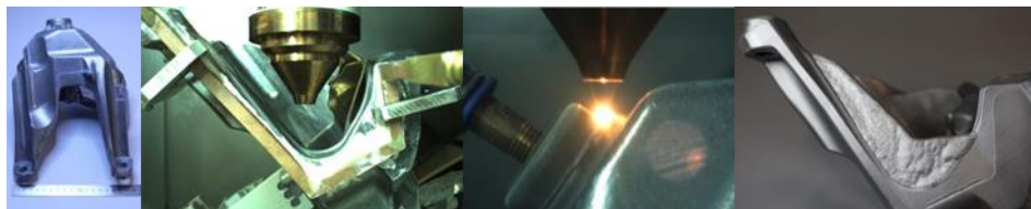
Abbildung 1: Hybridfertigung beim Laser-Auftragschweißen
