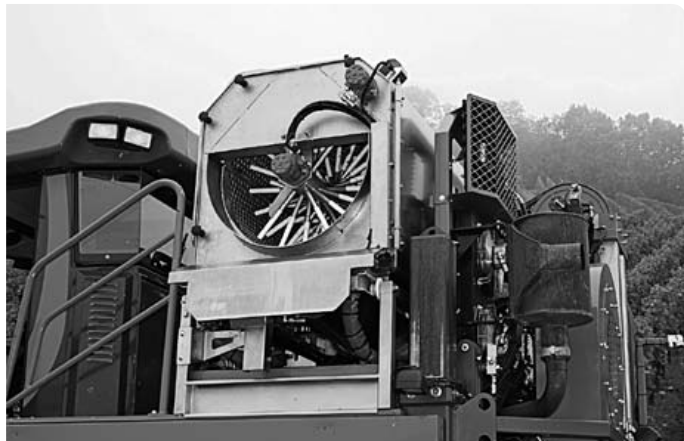
Abb. 2. Abnehmbarer Entrapper auf einem ERO-Traubenvollernter.
