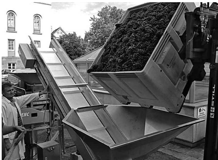
Abb. 4. Traubentransportsystem mit kleineren Behältern (Boxen) bis 500 kg: a) Kleinkisten, b) & c) Einheitsbehälter.
