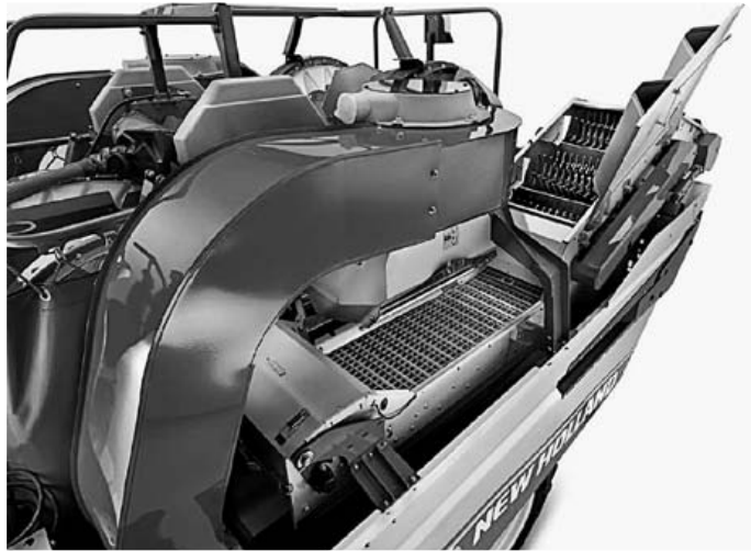
Abb. 1. Entrapper Euroselect über dem Traubenbehälter eines modernen Traubenvollernters
